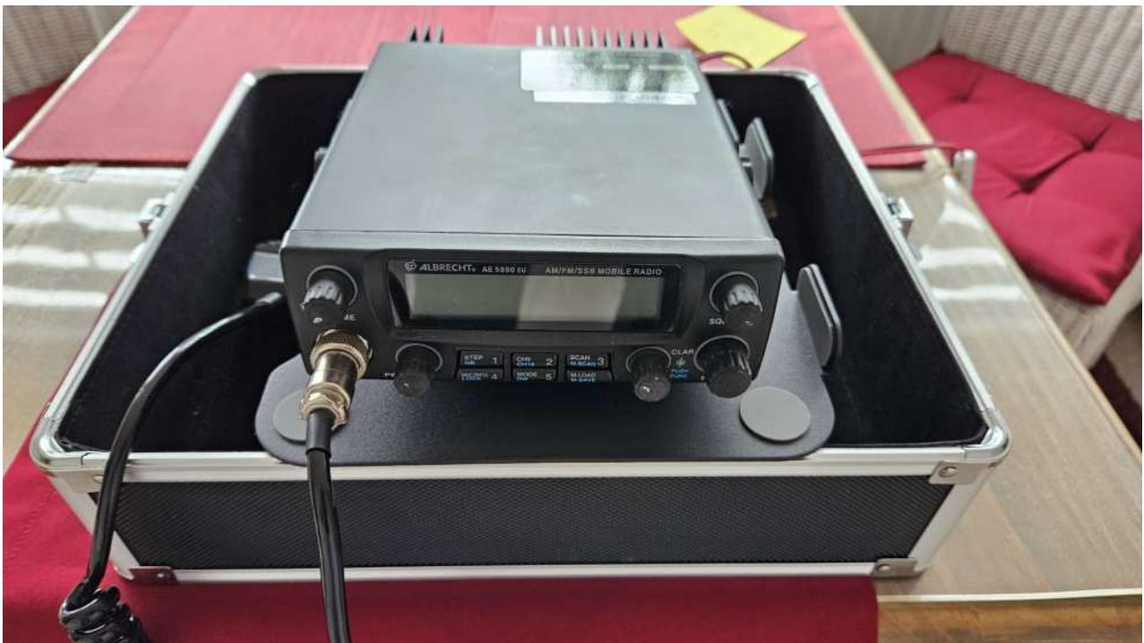
Funkgerät montiert, angehoben und gedreht (Kante stützt sich ab)
