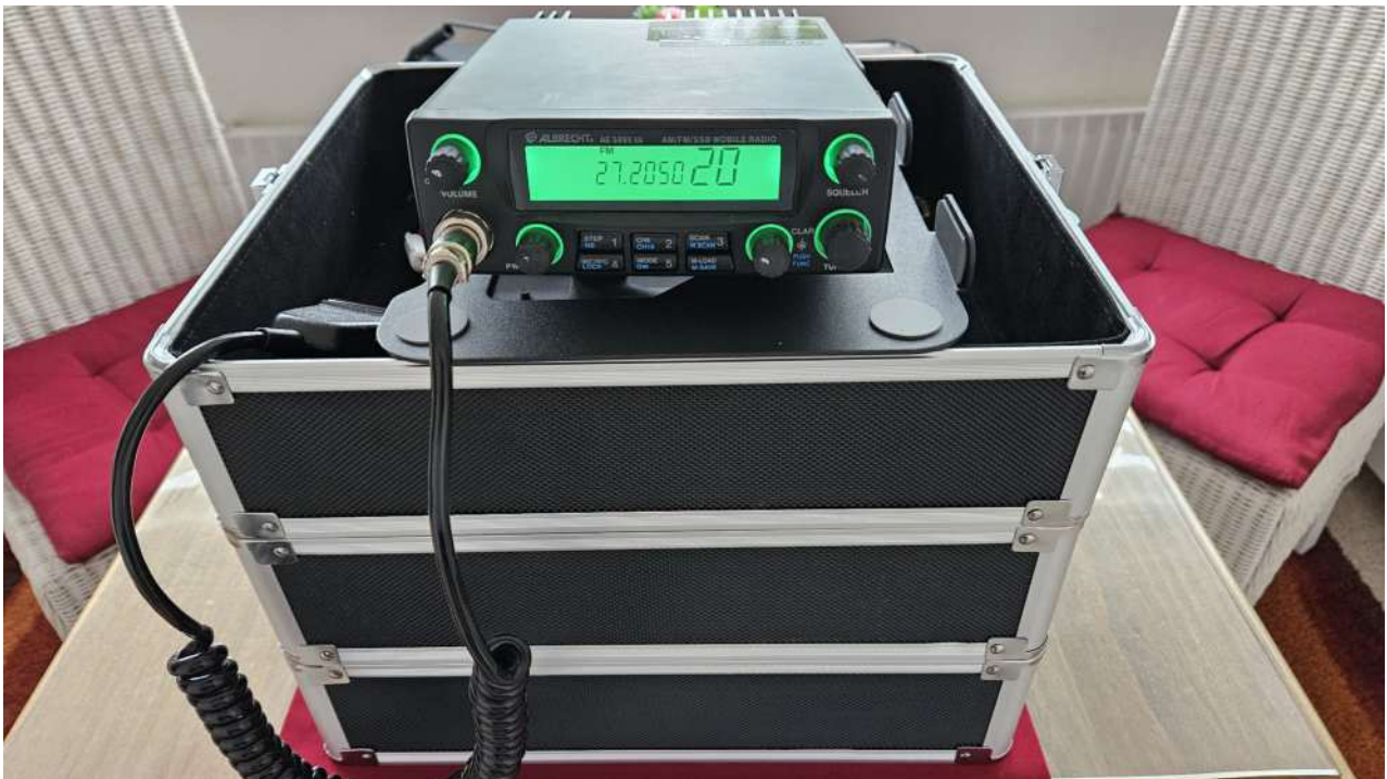
3 Etagen aufgebaut und Akkubetrieb
