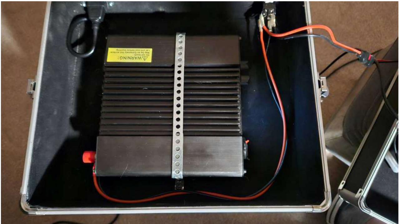
2. Etage Netzteil, oben links 230V, Kaltgerätebuchse, Winkelstecker zum Netzteil, oben rechts Schalter mit Kabelanschlüssen, Netzteil mit Lochblechstreifen befestigt
