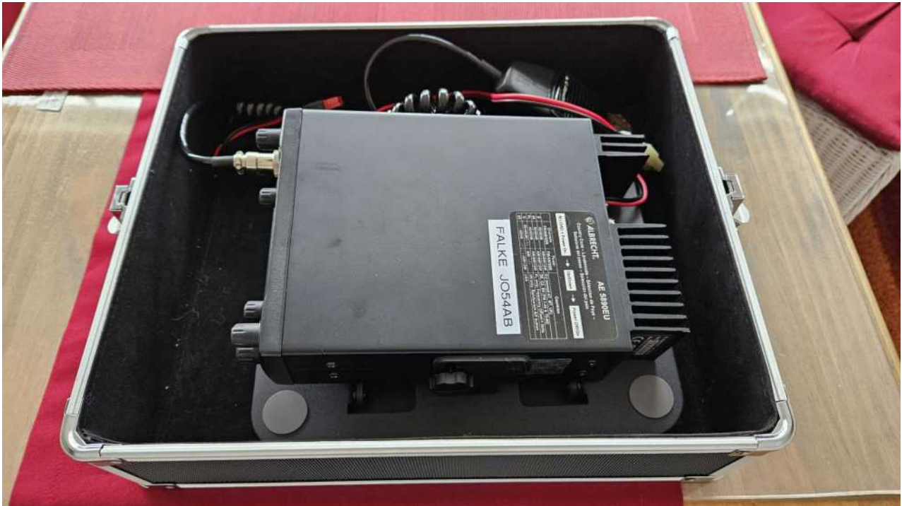
Funkgerät gedreht und abgesenkt (so kann der Deckel geschlossen werden)
